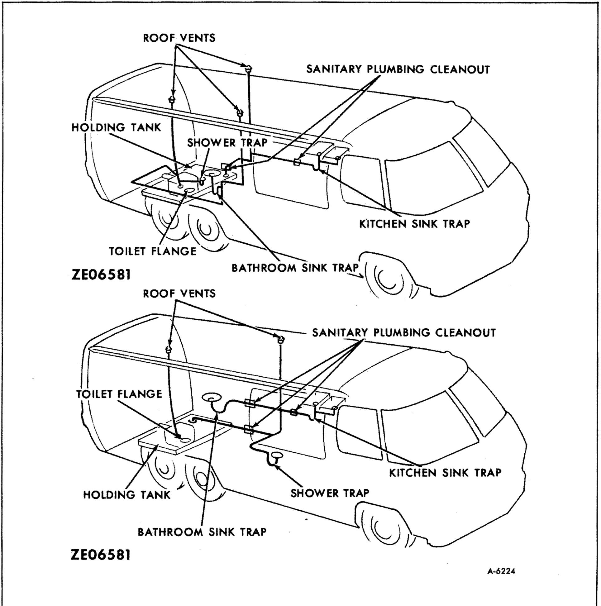
Figure 1—Drainage System (Models ZEO6581 and ZEO6582)
